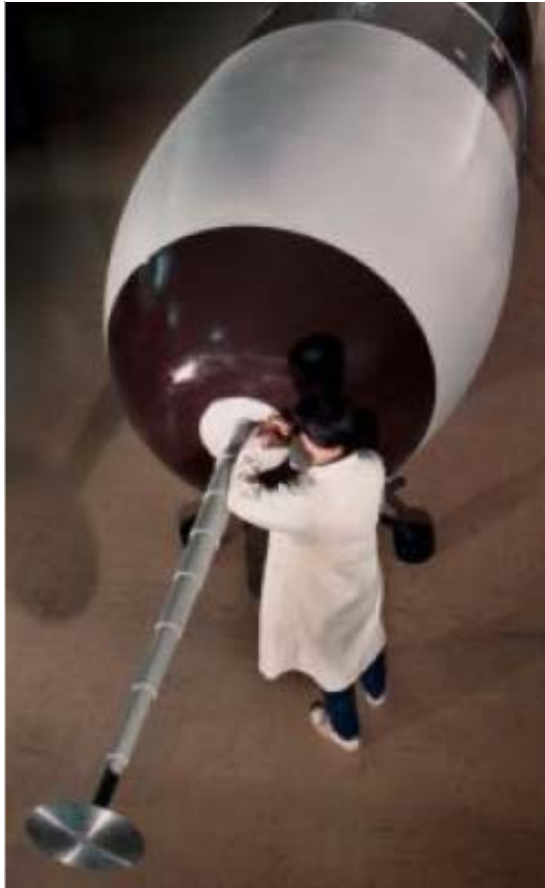
Bild II.29a Strömungsfeld vor einem stumpfen Körper mit einem Aerospike.
