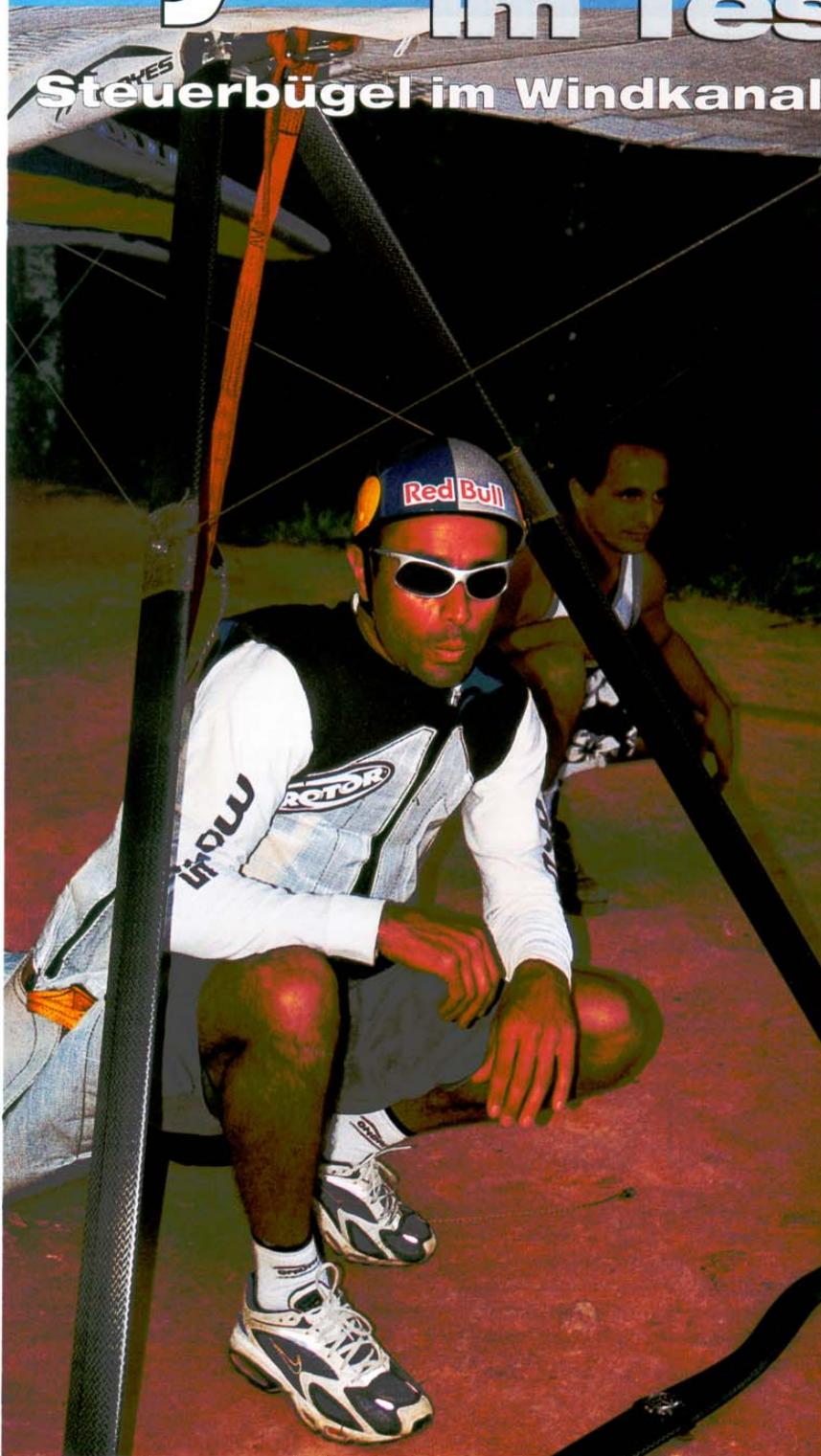
In Wettkämpfen sieht man sie schon länger, inzwischen auch zunehmend bei Piloten, die nur zum Spaß Strecken fliegen: stromlinienförmige, sehr dünne Steuerbügel. Als Einzelanfertigung sind die schnittigen Streben von verschiedenen Herstellern zu haben, in Serie produziert sie bis jetzt nur Wills Wing. Sehen die vorwiegend aus Carbon gefertigten Trapezteile nur so aus, oder sind sie tatsächlich widerstandärmer als herkömmliche?
