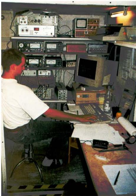
Windkanal-Messplatz: Rüdiger Keck bei der Durchführung und Auswertung der Tests
