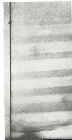
Abb. 9. Zur Messung der Geschwindigkeitskomponenten v und w wird die Tellurwolke durch Lackierung des Tellurdrahts in bestimmten Wandabständen unterbrochen.
