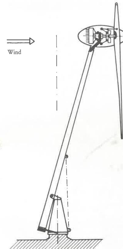
Abbildung 5. Übersichtsskizze der Einblatt-Turbine „FLAIR“
