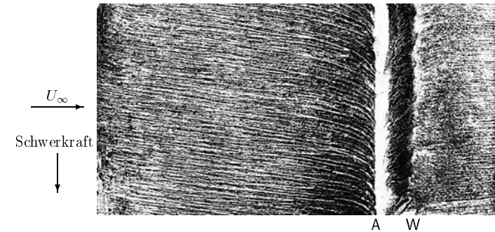
Abbildung 1.4: Wandanstrichbild einer Tragflügelprofilströmung mit transistionaler laminarer Ablöseblase (W. Würz, Universität Stuttgart). Ablöselinie A, Wiederanlegelinie W.
